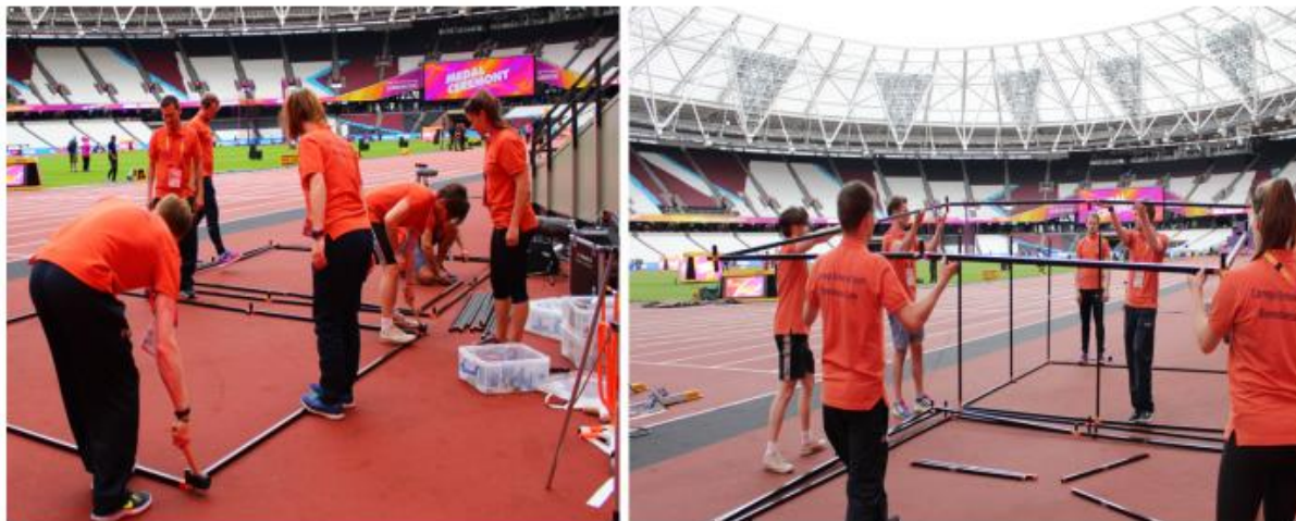
Slika 2. Postavljanje i snimanje kuboidnog kalibracijskog okvira
