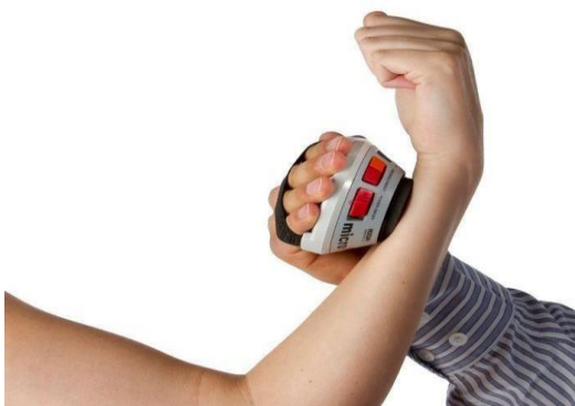
Slika 10. Prikaz korištenja ručnog dinamometra (slika preuzeta s mrežne stranice Web 7)
