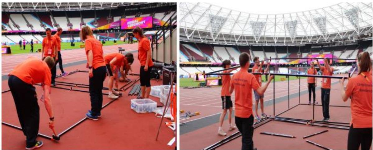
Slika 2. Postavljanje i snimanje kuboidnog kalibracijskog okvira
