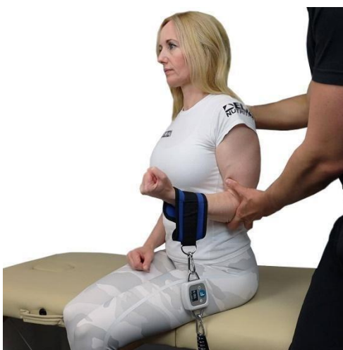
Slika 12. Prikaz korištenja fiksnog dinamometra (slika preuzeta s mrežne stranice Web 8)
